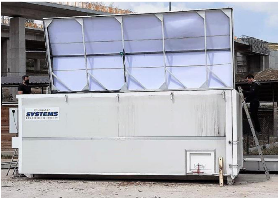
Obr. 3.14 Hygienizačné zariadenie – CSC kontajner na kompostovanie bioodpadu
