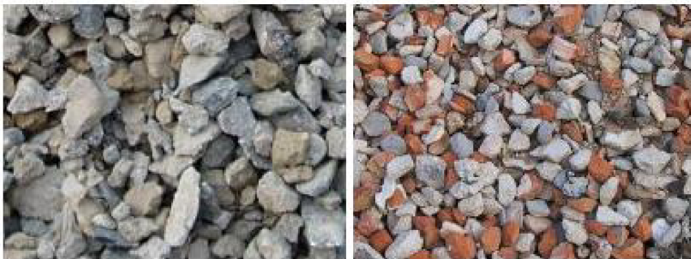
Obr. 3.10 Betónová a tehlová drť spracovaná zo stavebného odpadu
