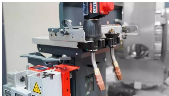
Obr. 21 Výmenná stanica Fronius Robacta TX/i [28]
