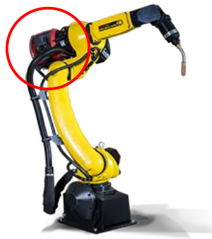
Obr. 13 Robot FANUC ARC Mate 100iC/12 s integrovaným podávačem drôtu od firmy Fronius [71]
