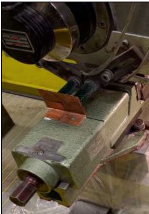
Obr. 36 – Simulování šířky obrobku pomocí kovového plechu.
