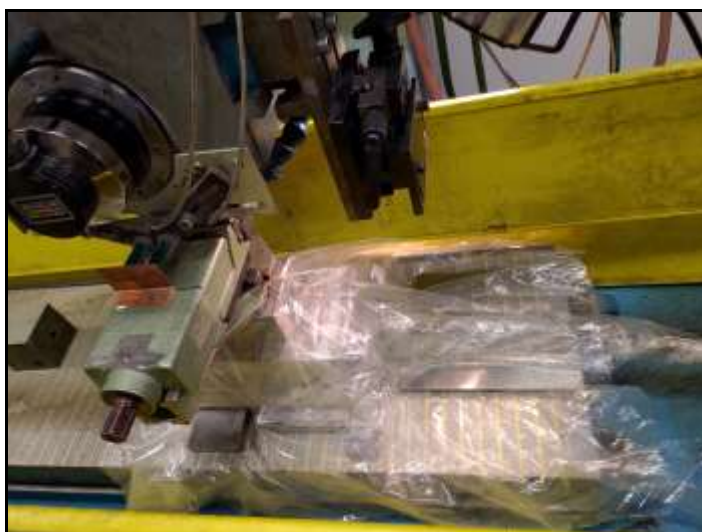
Obr. 31 – Ochrana dynamometru před procesní kapalinou.
