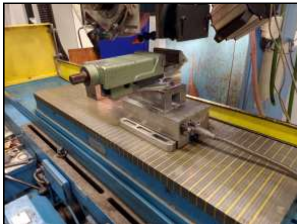
Obr. 29 – Dynamometr upnutý na elektromagnetické desce s připevněným strojním svěrákem.
