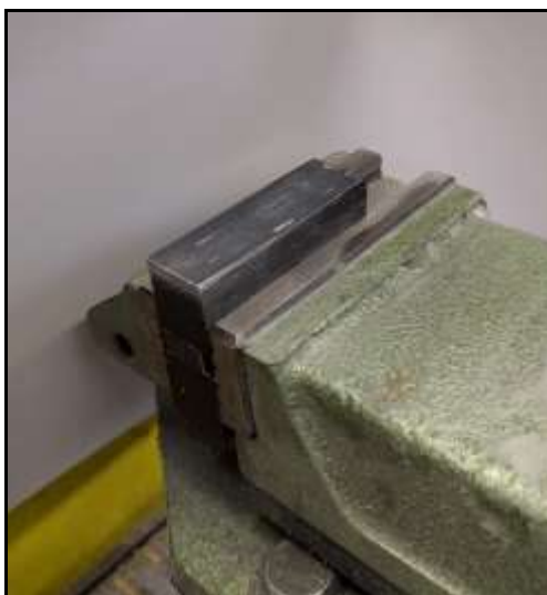
Obr. 27 – Upnutí vzorku pomocí strojního svěráku.
