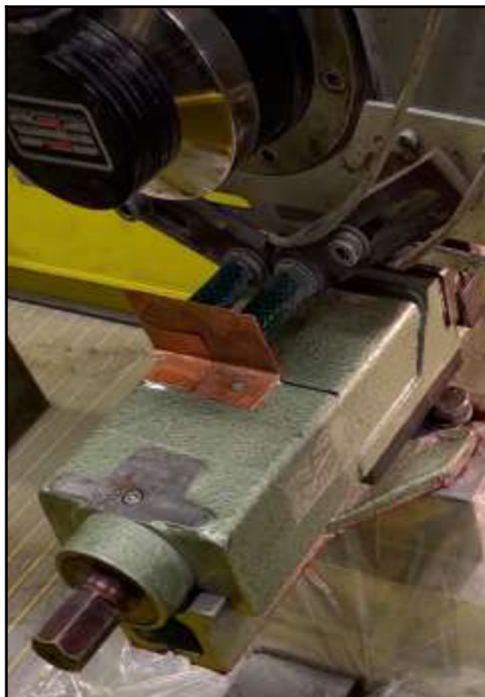
Obr. 36 – Simulování šířky obrobku pomocí kovového plechu.
