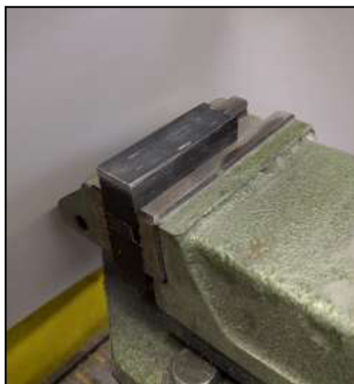
Obr. 27 – Upnutí vzorku pomocí strojního svěráku.
