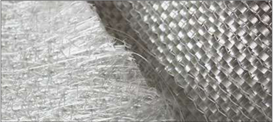
Obr. 4 – Skelná vlákna, vlevo skelná rohož, vpravo skelná tkanina. [28]
