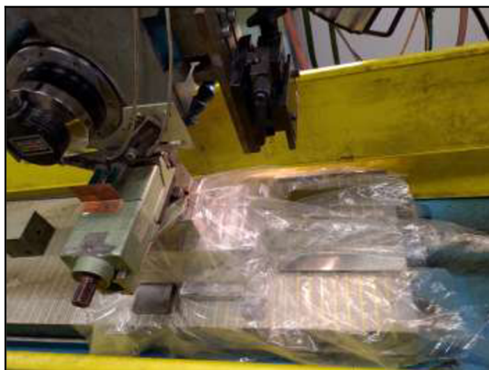
Obr. 31 – Ochrana dynamometru před procesní kapalinou.
