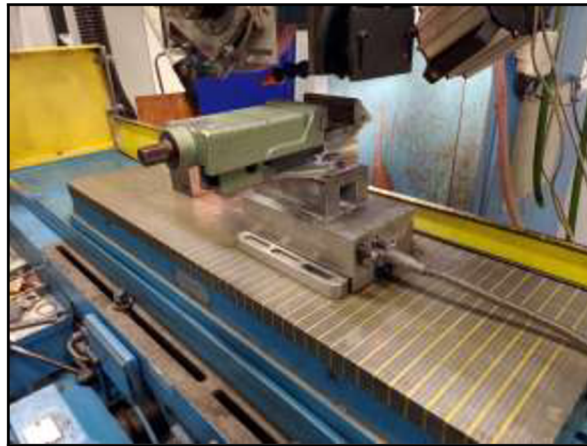
Obr. 29 – Dynamometr upnutý na elektromagnetické desce s připevněným strojním svěrákem.
