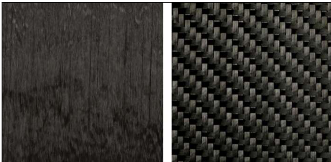
Obr. 3 – Textilie z uhlíkových vláken, vlevo s uniformní orientací vláken, vpravo úplet. [13]
