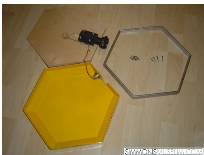
Obrázek 2.1: Rozbraný pad SDS 5 obsahující dřevěnou desku. Převzato z [1].
