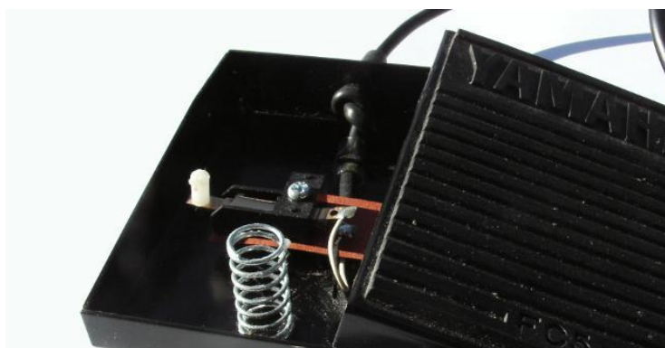
Obrázek 2.5: Vnitřek sustain pedálu použitého jako spínač hi-hat.
