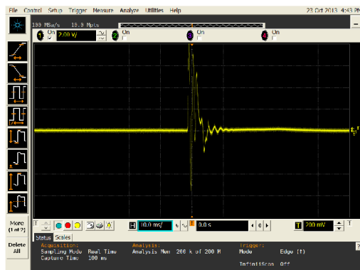
Obrázek 3.2: Průběh napětí na piezoměniči při úderu, časová osa 10 ms / div.
