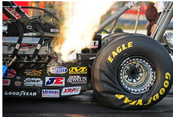
Obr. 28 Deformace pneumatiky dragsteru při akceleraci [29]
