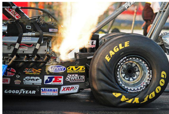
Obr. 28 Deformace pneumatiky dragsteru při akceleraci [29]
