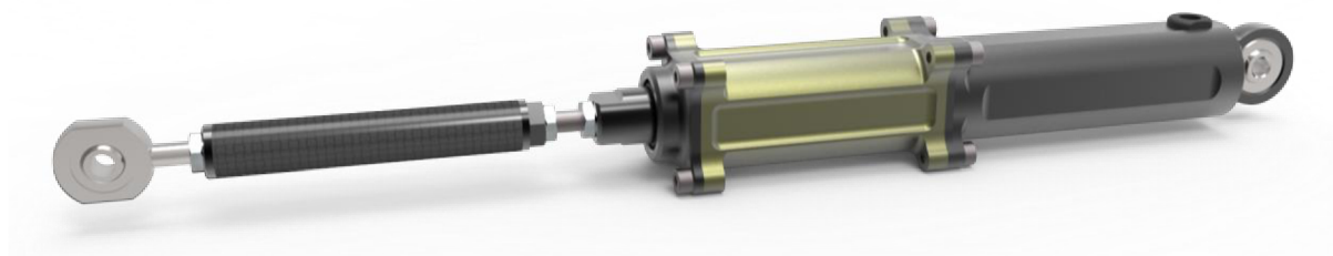
Obr. 96 Sestava aktuátoru zadního řízení
