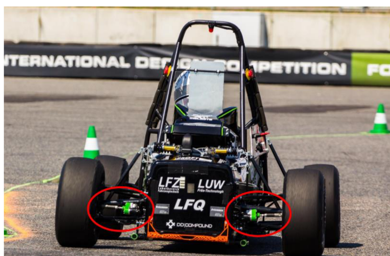
Obr. 11 Vozidlo týmu Ignition Racing Team Electric vybaveno řízením zadních kol [20]
