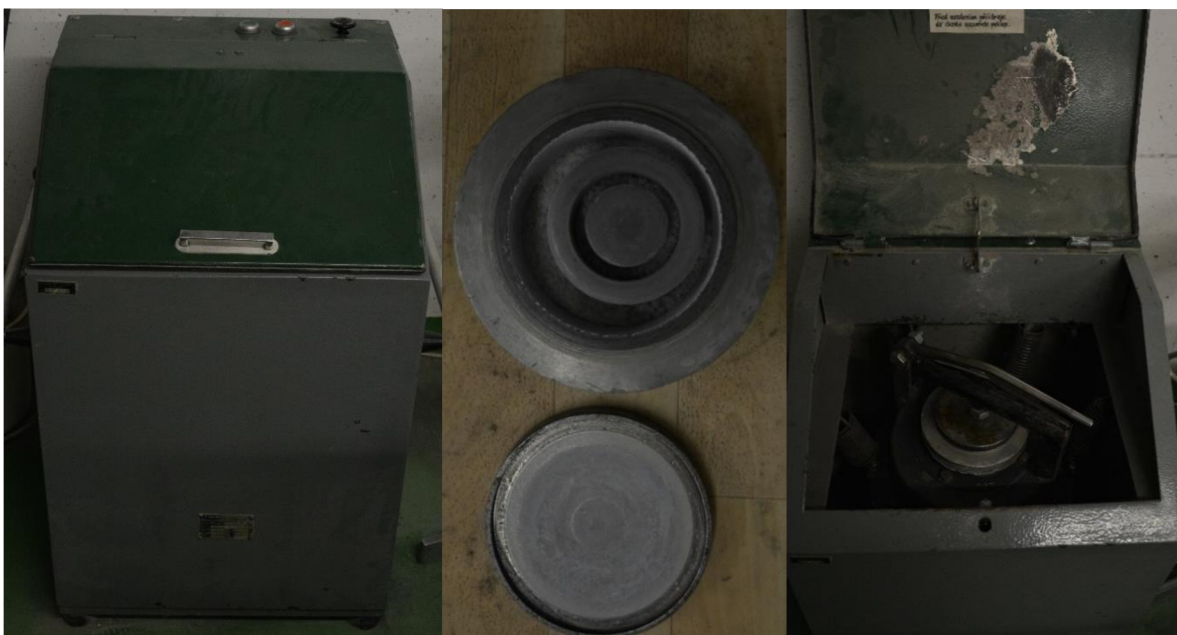
Obr. 15: Vibrační prstencový mlýnek.
