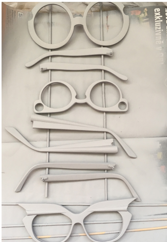
Obr. 37 Tmelení nerovností a příprava před lakováním
