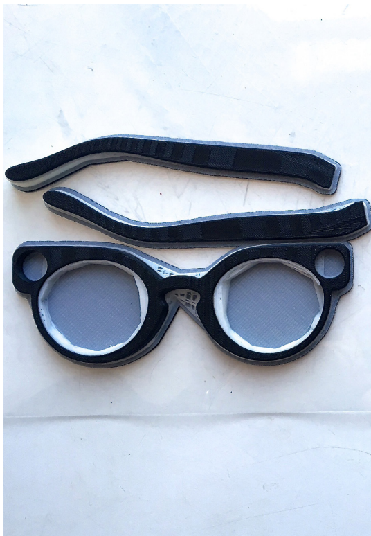
Obr. 35 Vytisknuté obruby a stranice na 3D tiskárně, ABS plast a podpora tisku
