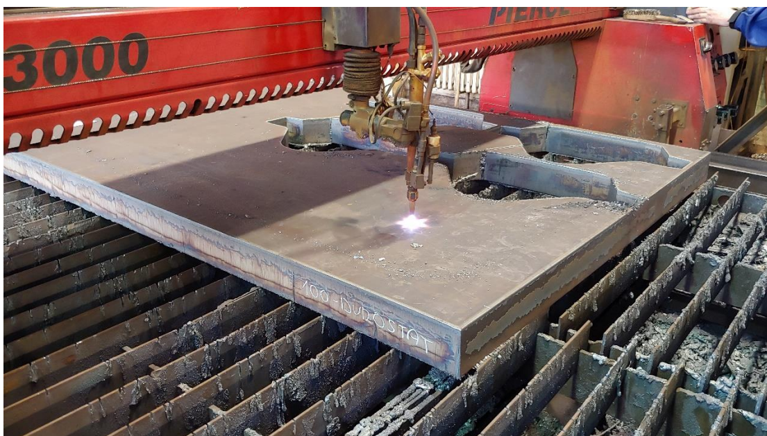
Obr. 12 Řezání kyslík-acetylenovým hořákem na stroji PIERCE RUR 3000.
