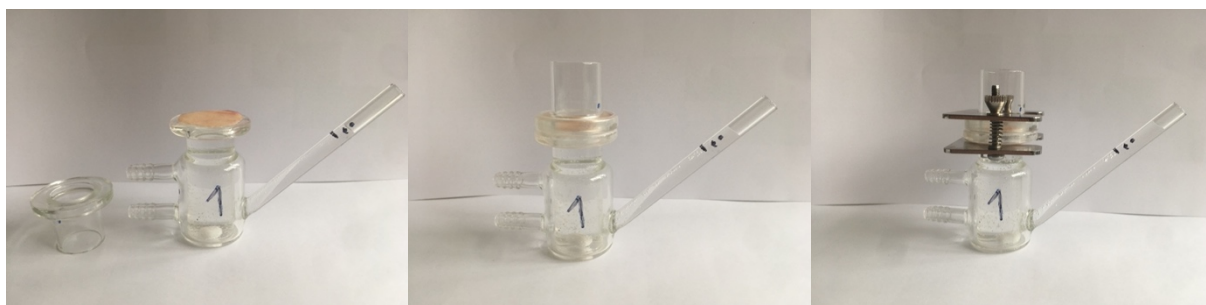
Obrázek 19: Rozmrzlá membrána vložena na otvor receptorové komory (vlevo), mezera mezi donorovou a receptorovou komorou zajištěna parafilmem (uprostřed), obě komory zajištěné kovovou svorkou (vpravo)
