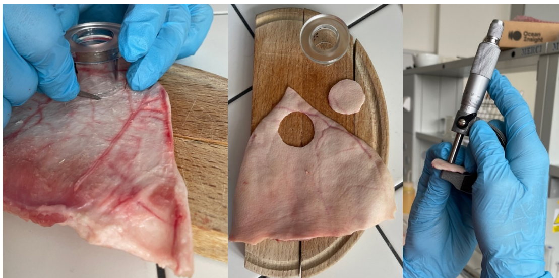
Obrázek 17: Donorová část Franzovi difuzní cely použita jako předloha pro kožní membránu (vlevo), vyříznutá kožní membrána (uprostřed), měření tloušťky membrány pomocí mikrometru (vpravo)
