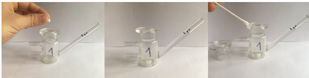
Obrázek 18: Vložení míchátko do receptorové komory (vlevo), receptorová komora naplněna přijímací tekutinou (uprostřed), Styčné plochy natřené silikonovou pastou na zábrusy (vpravo)
