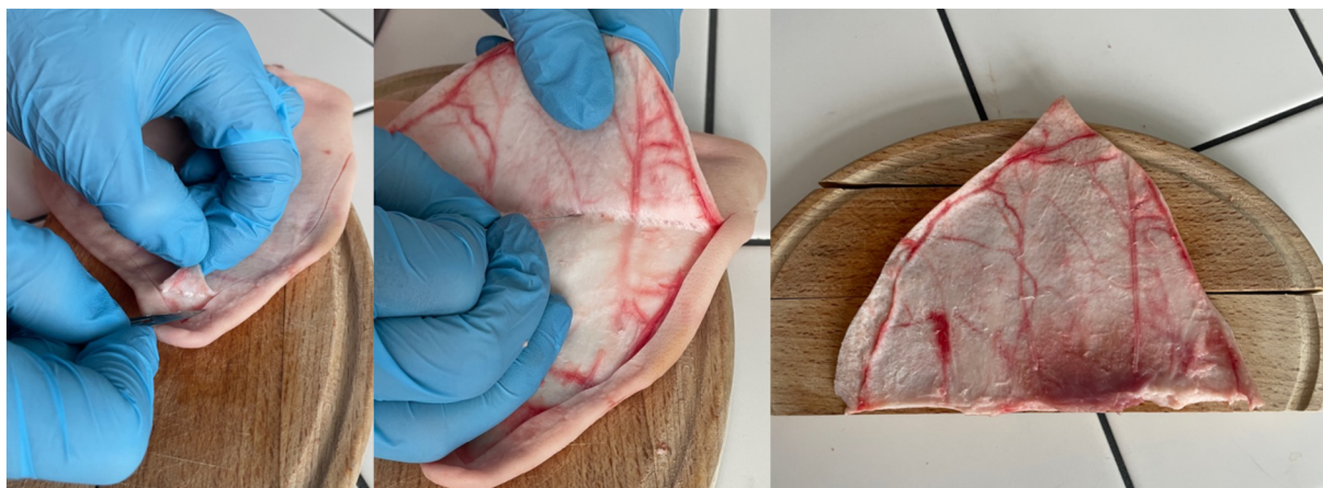
Obrázek 16: Počáteční izolace kůže od zbytku kožní struktury (vlevo), izolace kůže pod úhlem 45°(uprostřed), izolovaná kůže připravená na úpravu tvaru (vpravo)
