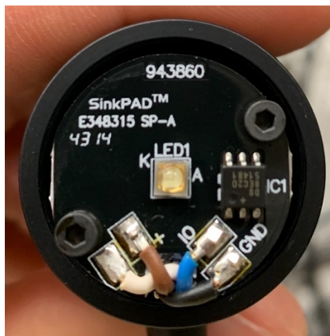
Obr. 35 Detail čipu zelené LED diody (Zdroj: Autor)
