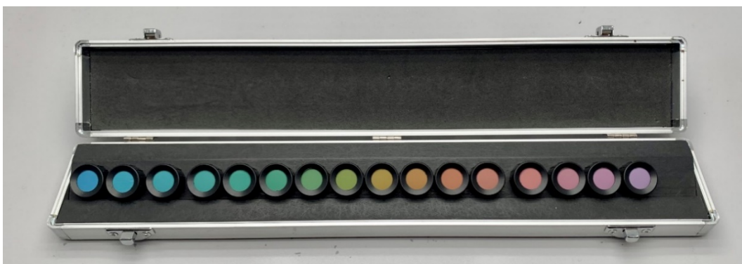
Obr. 7 Ukázka Farnsworth-Munsell D15 testu v laboratoři LCAM TUL (Zdroj: Autor)
