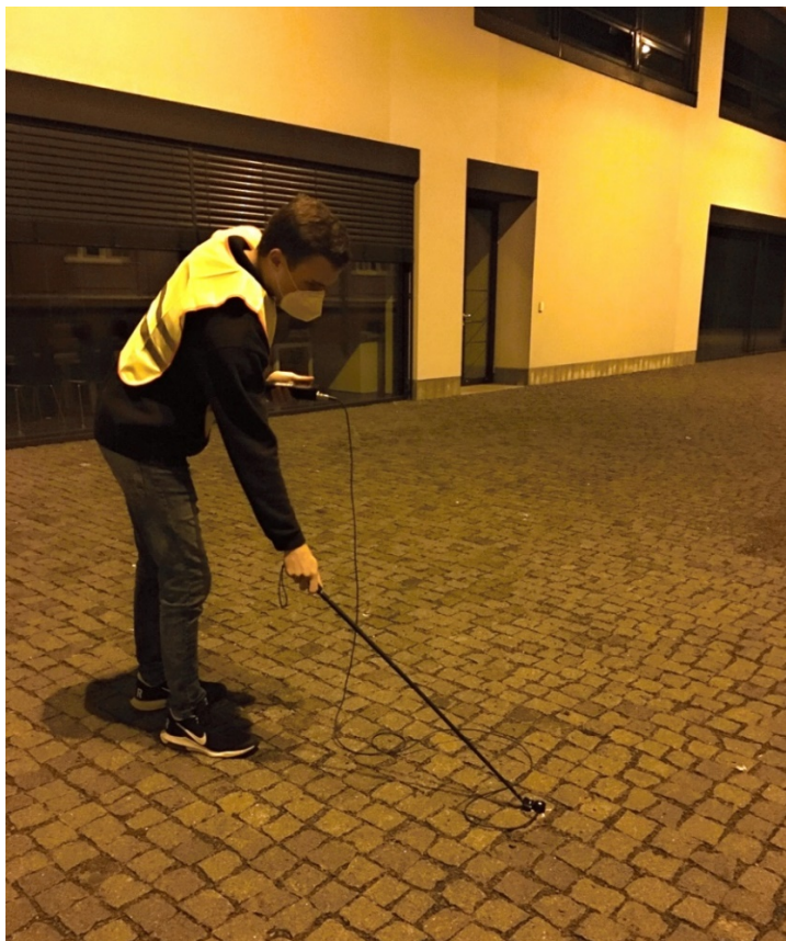
Obr. 38 Ukázka měření osvětlenosti pomocí luxmetru (Zdroj: Autor)
