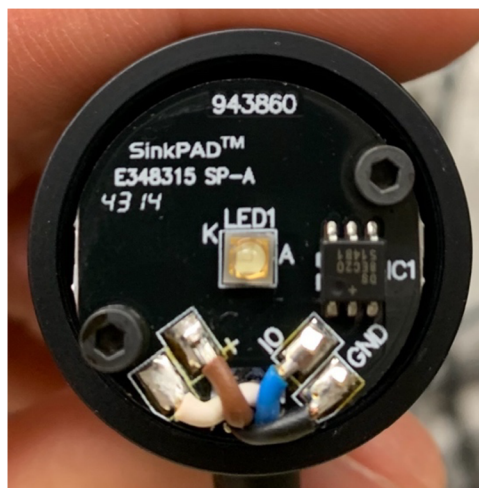
Obr. 35 Detail čipu zelené LED diody (Zdroj: Autor)
