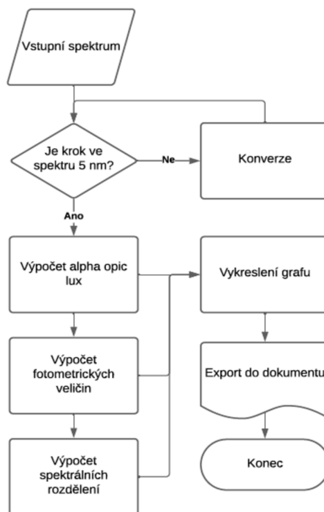
Obr. 41 Zjednodušený vývojový diagram analytického software
