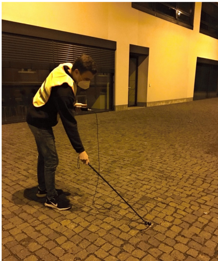
Obr. 38 Ukázka měření osvětlenosti pomocí luxmetru (Zdroj: Autor)
