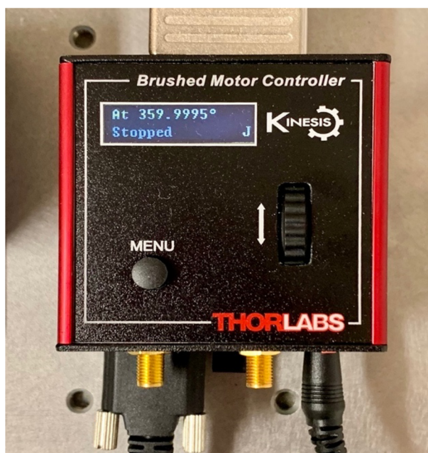
Obr. 50 Ovladač elektronického stolku Kinesis (Zdroj: Autor)
