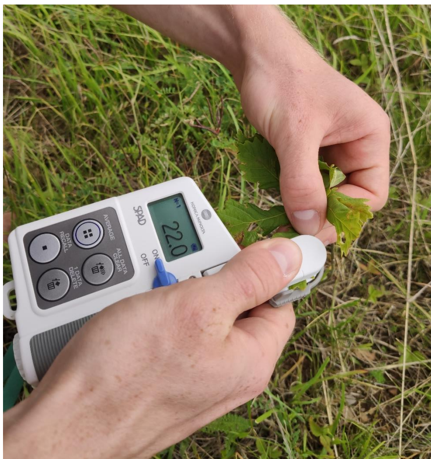
Obr. 5: Sběr SPAD hodnot pomocí chlorofylmetru (Foto Ivana Tomášková)
