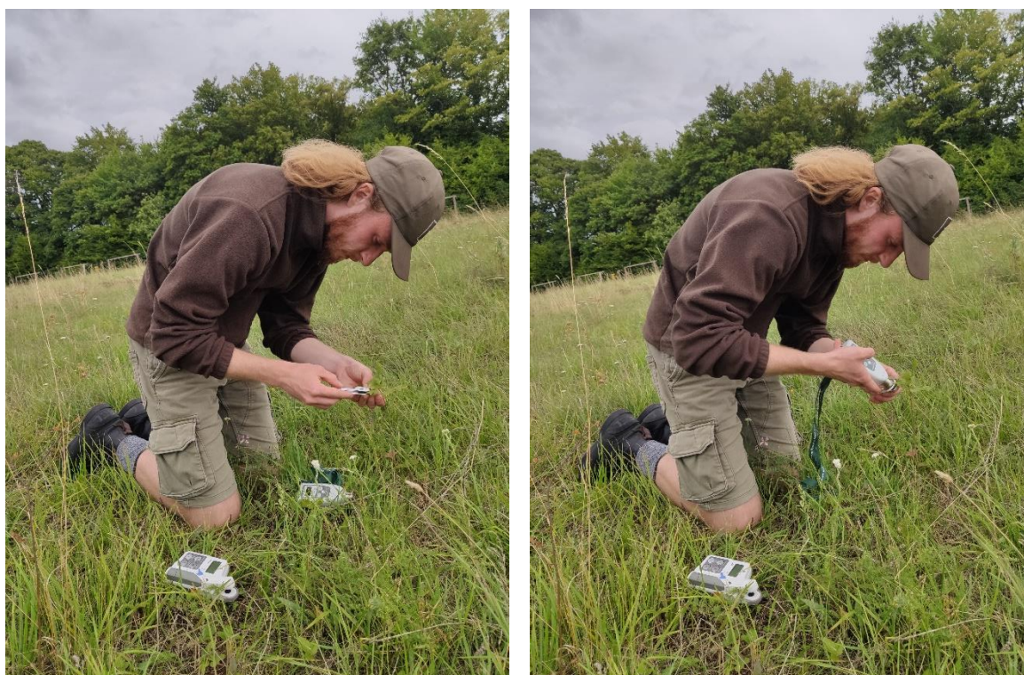
Obr. 6: Umisťování klipu na list a měření OJIP křivky pomocí přístroje FluorPen (Foto Ivana Tomášková)
