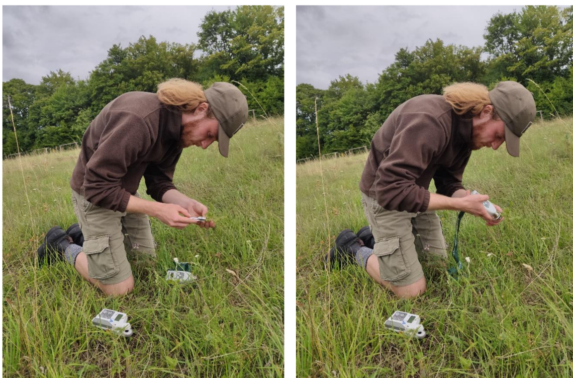
Obr. 6: Umístování klipu na list a měření OJIP křivky pomocí přístroje FluorPen (Foto Ivana Tomášková)
