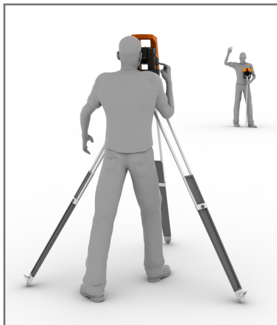
Obr. 64 Běžná metoda měření ve dvou osobách.
