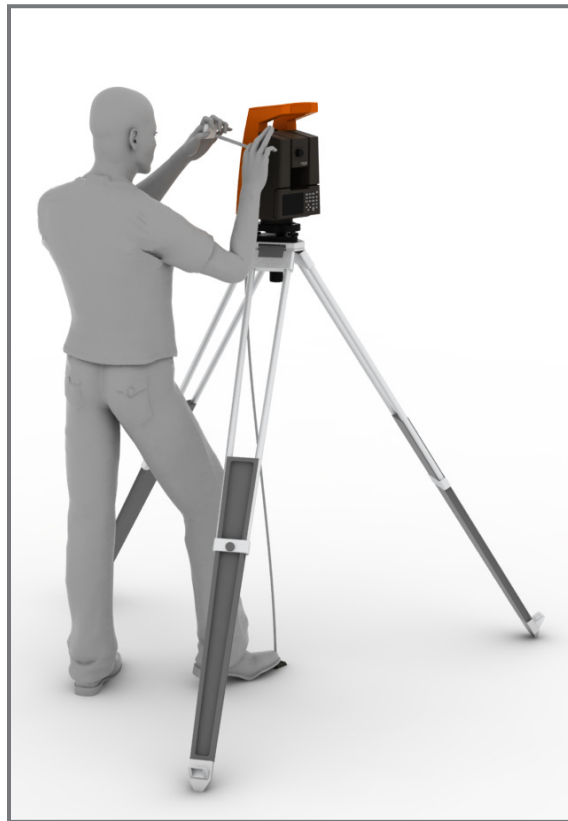
Obr. 63 Měření výšky klopné osy od stabilizačního znaku.
