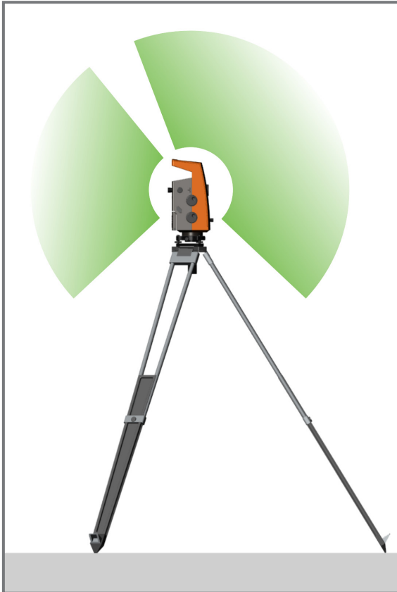
Obr. 50 Rozsah úhlů, které je možné použít pro pozorování prostřednictvím okuláru nebo kamery.
