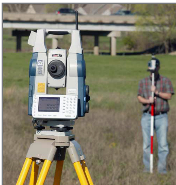
Obr. 19 Měření s robotizovanou stanicí Sokkia.
