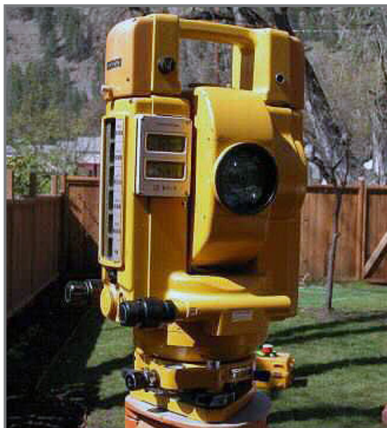
Obr. 28 Totální stanice Topcon ET-1.
