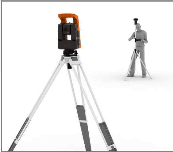
Obr. 65 Měření v automatickém režimu totální stanice.
