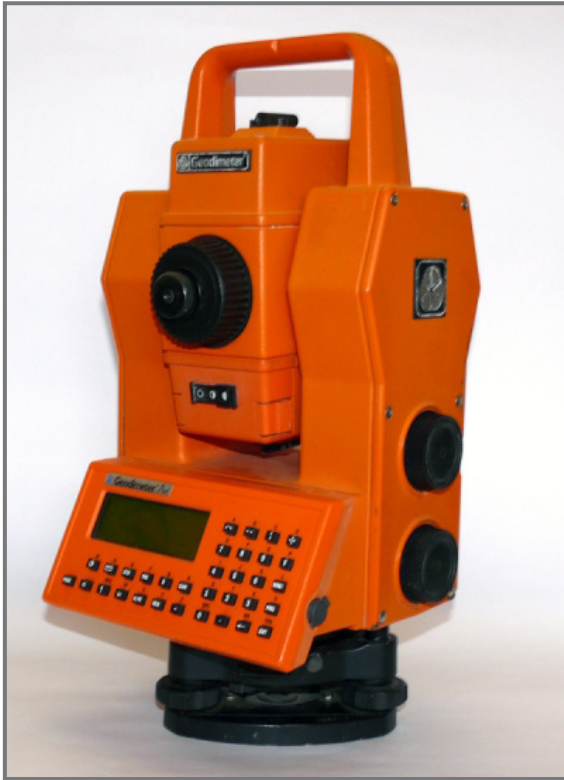
Obr. 7 Totální stanice Geodimeter 620 z roku 1994.
