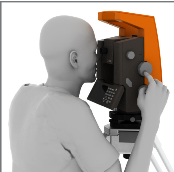
Obr. 56 Ovládání ustanovky jedním prstem.
