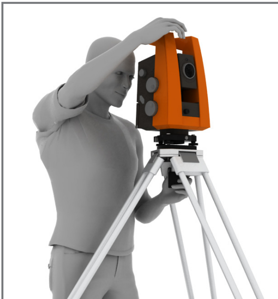
Obr. 51 Připevnění totální stanice na stativ středovým přichytným šroubem.
