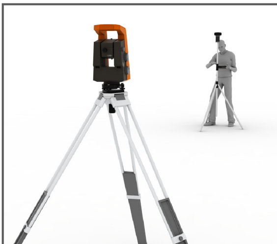
Obr. 65 Měření v automatickém režimu totální stanice.
