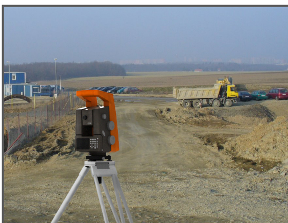
Obr. 67 Použití totální stanice v terénu.
