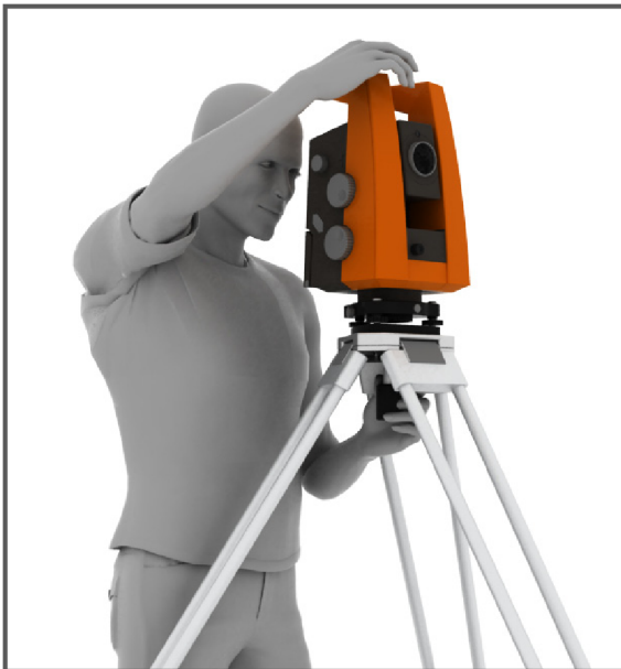
Obr. 51 Připevnění totální stanice na stativ středovým přichytným šroubem.
