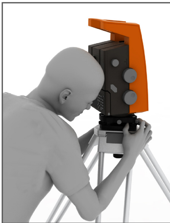
Obr. 53 Horizontace se provádí otáčením stavěcích šroubů na trojnožce.
