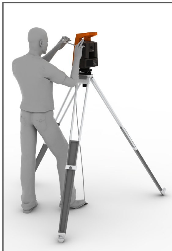
Obr. 63 Měření výšky klopné osy od stabilizačního znaku.
