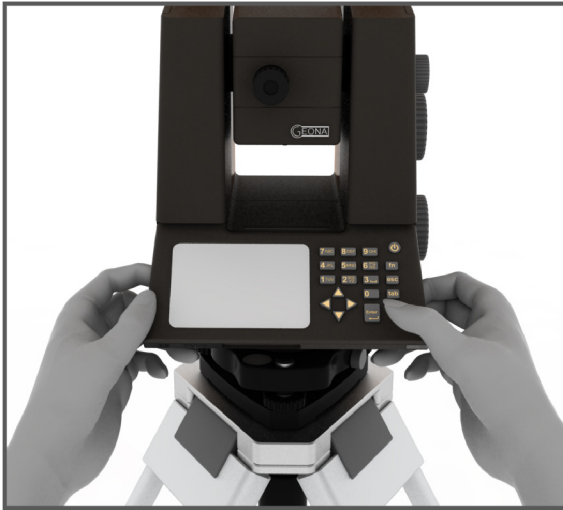
Obr. 60 Použití klávesnice na ovládacím panelu.
