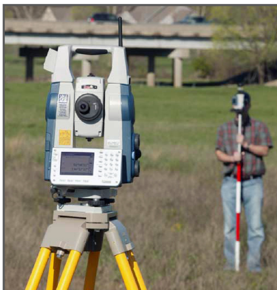
Obr. 19 Měření s robotizovanou stanicí Sokkia.
