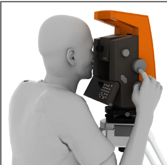
Obr. 56 Ovládání ustanovky jedním prstem.
