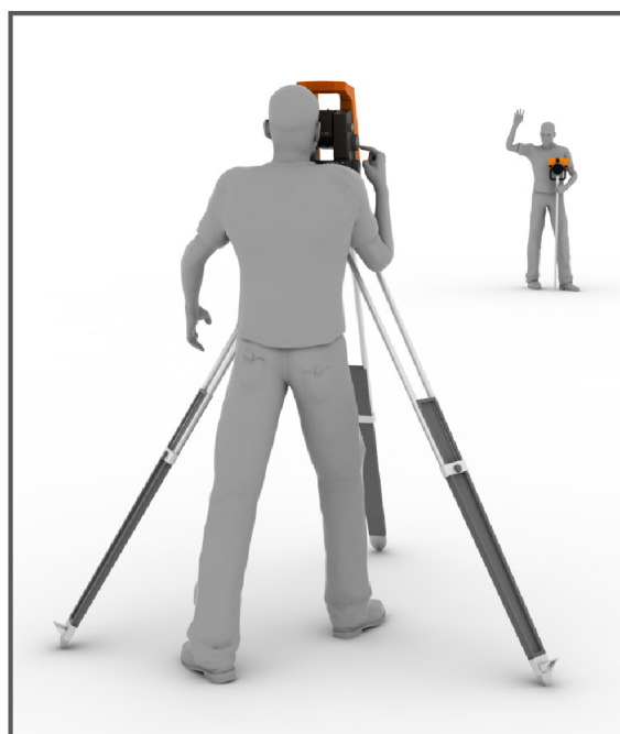
Obr. 64 Běžná metoda měření ve dvou osobách.
