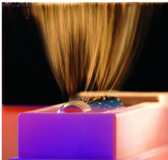
Obrázek 4 - Válcová elektroda v provozu [7]
