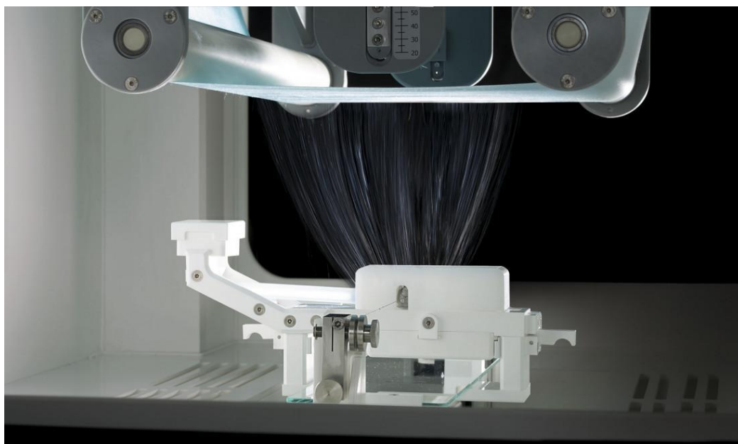
Obrázek 6 - Strunová elektroda v provozu [10]
