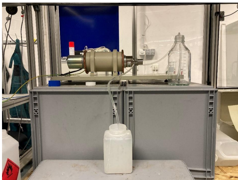
Obrázek 45 - Měření průtoku 10% roztoku PVB v ethanolu
