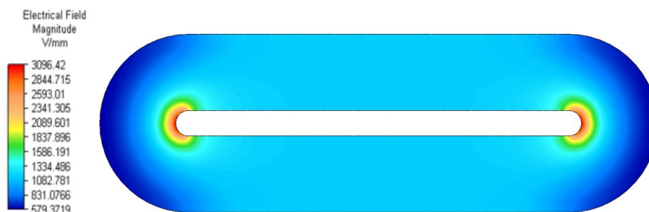
Obrázek 28 - Intenzita elektrického pole v okolí lineární elektrody
