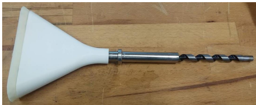
Obrázek 12 - Šnekový dopravník používaný pro čerpání polymerních roztoků
