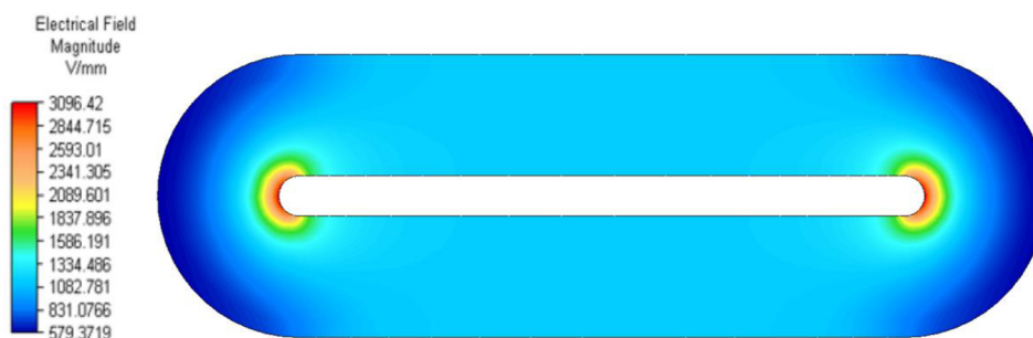
Obrázek 28 - Intenzita elektrického pole v okolí lineární elektrody
