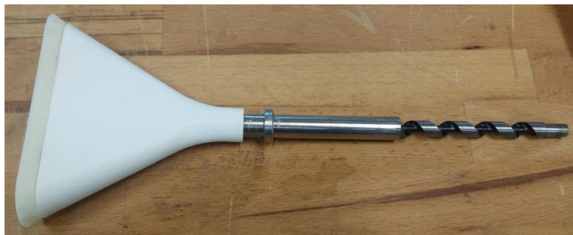
Obrázek 12 - Šnekový dopravnik používaný pro čerpání polymerních roztoků
