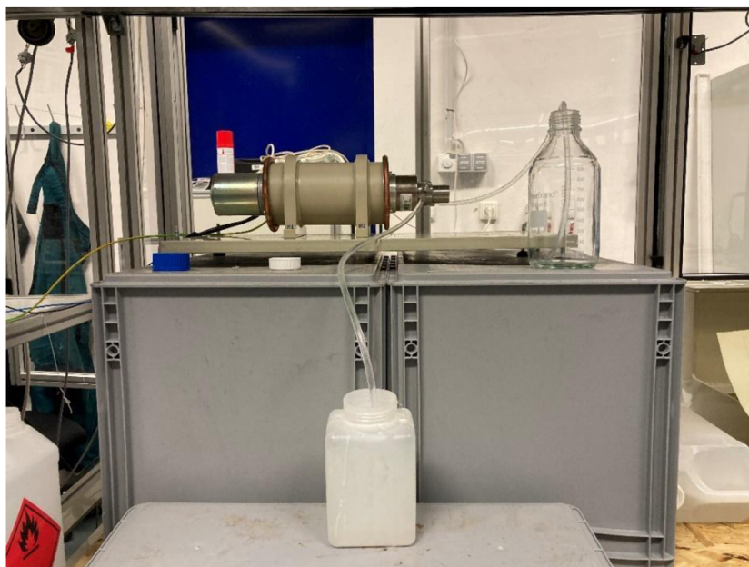
Obrázek 45 - Měření průtoku 10% roztoku PVB v ethanolu
