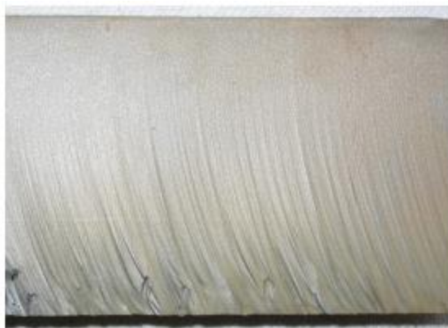
Obrázek 9 – Kvalita řezné plochy (ocel 11 523) [31]
