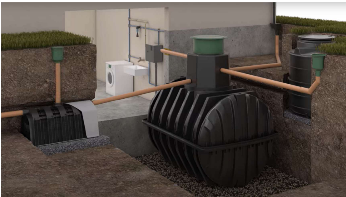
Obrázek 15 – Dešťová kanalizace před zasypáním, zdroj: [60]
