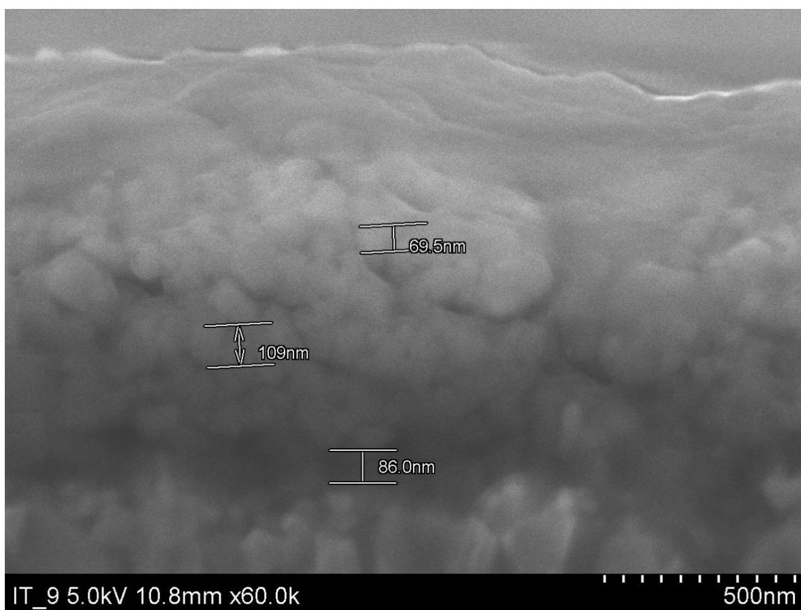
Obrázek 19: SEM snímek kokatalyzátoru \text{NiO}_x s vyznačenou tloušťkou nanočástiv
