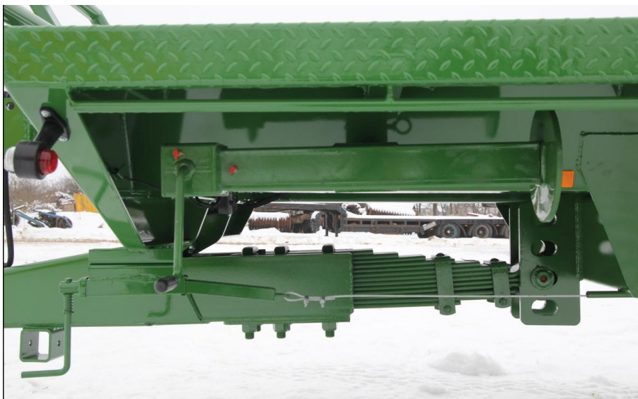
Obrázek 3.25: Návěs s odpruženou ojí pomocí listových per [45]
