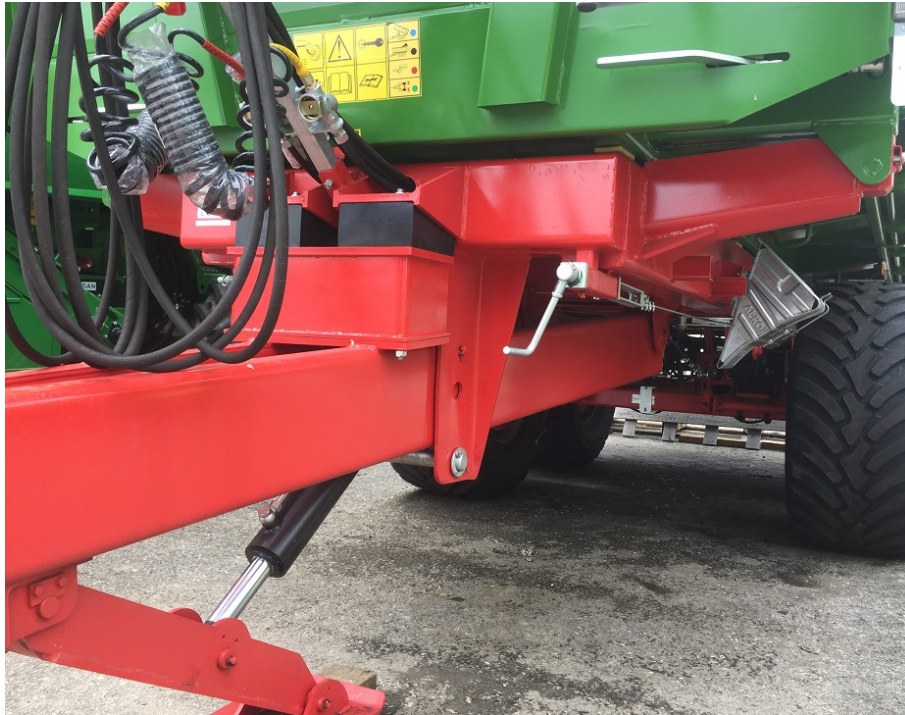
Obrázek 3.26: Návěs Pronar s odpruženou ojí pomocí silentbloků [18]
