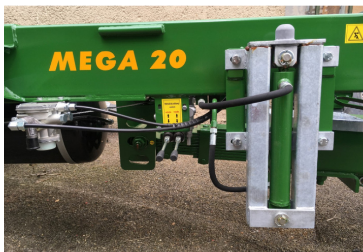
Obrázek 3.3: Přímočarý dvojitý hydromotor na podvozku návěsu ZDT MEGA [33]
