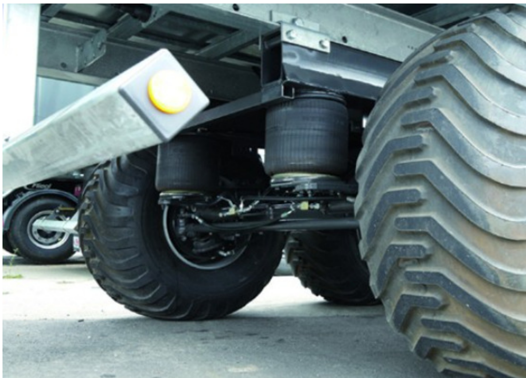
Obrázek 3.13: Pneumatické odpružení s nezávislými rameny [17]
