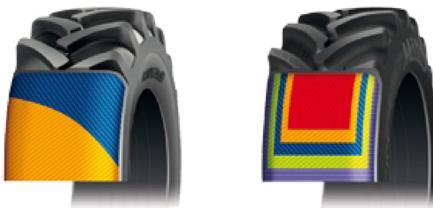
Obrázek 3.21: Diagonální a radiální konstrukce pláště [44]
