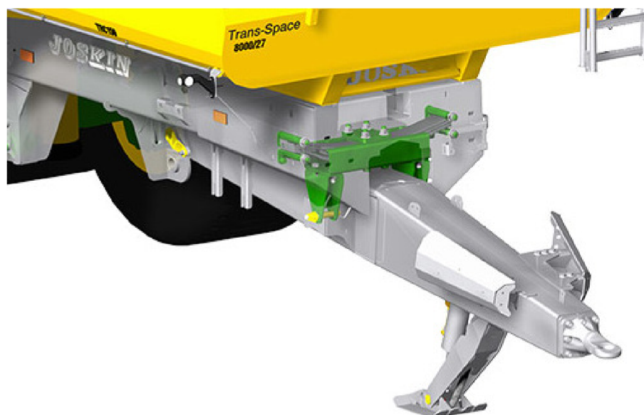
Obrázek 3.23: Návěs Joskin s odpruženou ojí pomocí parabolických per [14]
