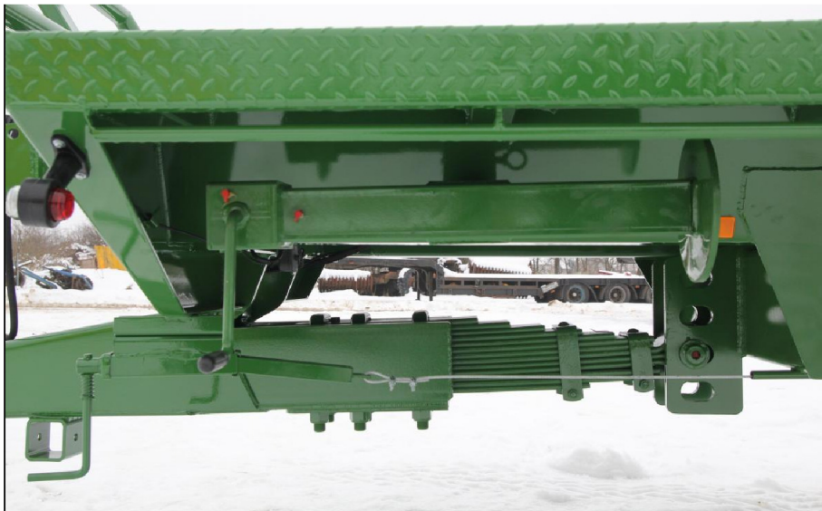
Obrázek 3.25: Návěs s odpruženou ojí pomocí listových per [45]
