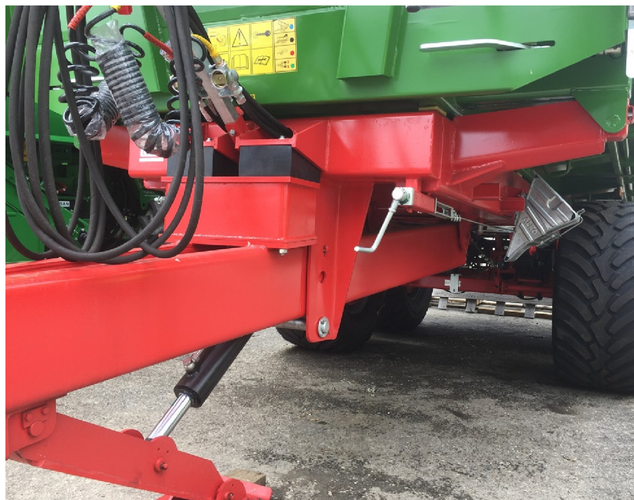
Obrázek 3.26: Návěs Pronar s odpruženou ojí pomocí silentbloků [18]
