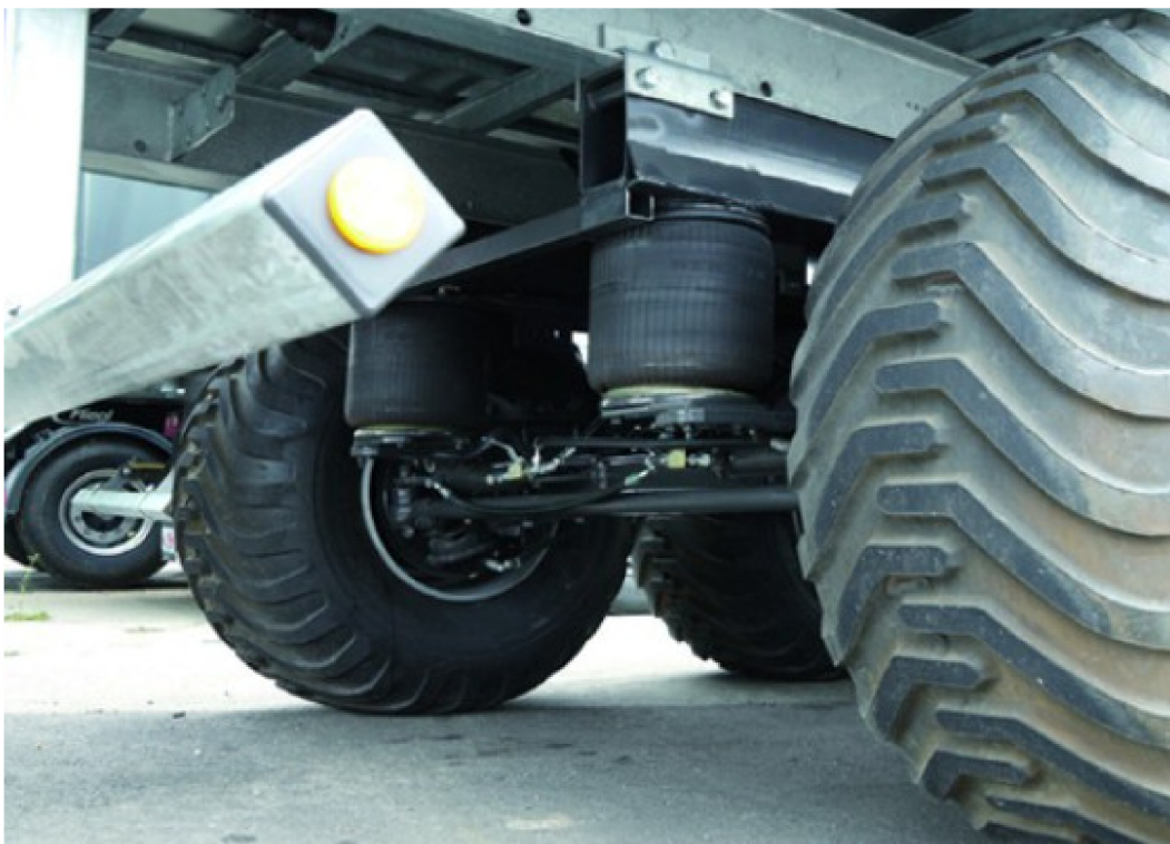
Obrázek 3.13: Pneumatické odpružení s nezávislými rameny [17]
