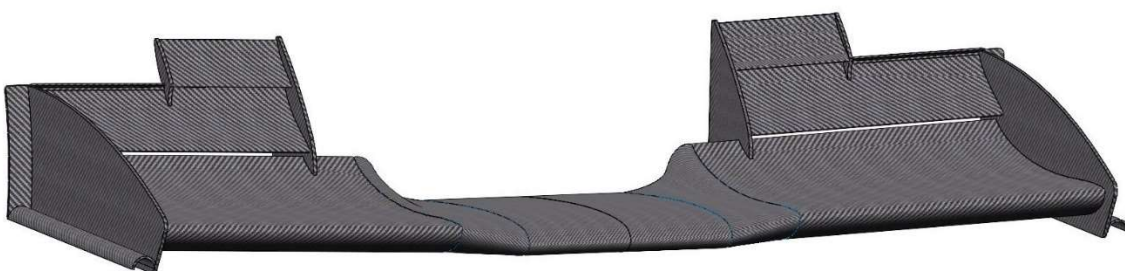
Obrázek č. 27 – Generační porovnání předního přitlačného křídla [autor práce]
