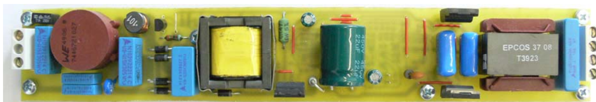
obr. P 10.13 Fotografie sestaveného předřadníku, horní strana
