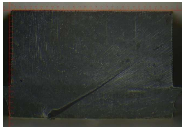
Obr. 50 Lom materiálu Standard po 10 min oplachu DPM.
