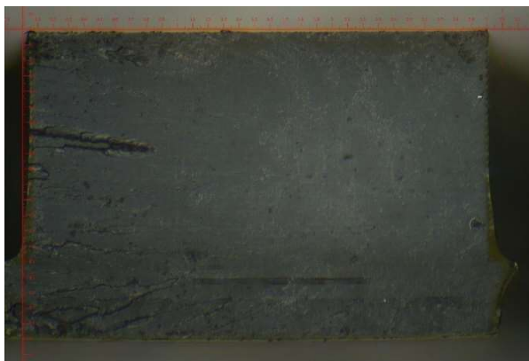
Obr. 49 Lom materiálu Standard bez oplachu.
