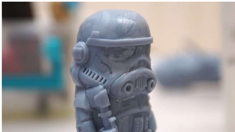
Obr. 22 Ukázka poškození povrchu 3D tištěného dílu po ručním oplachu [53].
