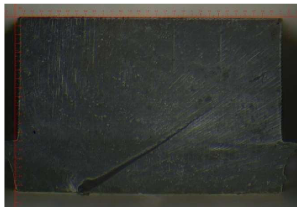
Obr. 50 Lom materiálu Standard po 10 min oplachu DPM.
