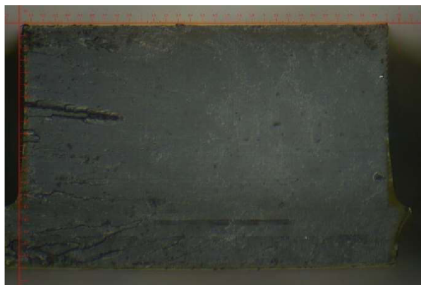
Obr. 49 Lom materiálu Standard bez oplachu.
