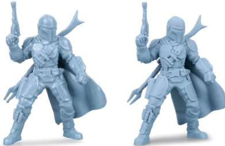
Obr. 2 Vlevo výrobek před oplachem a vytvrzením, vpravo výrobek po oplachu a vytvrzení [8].
