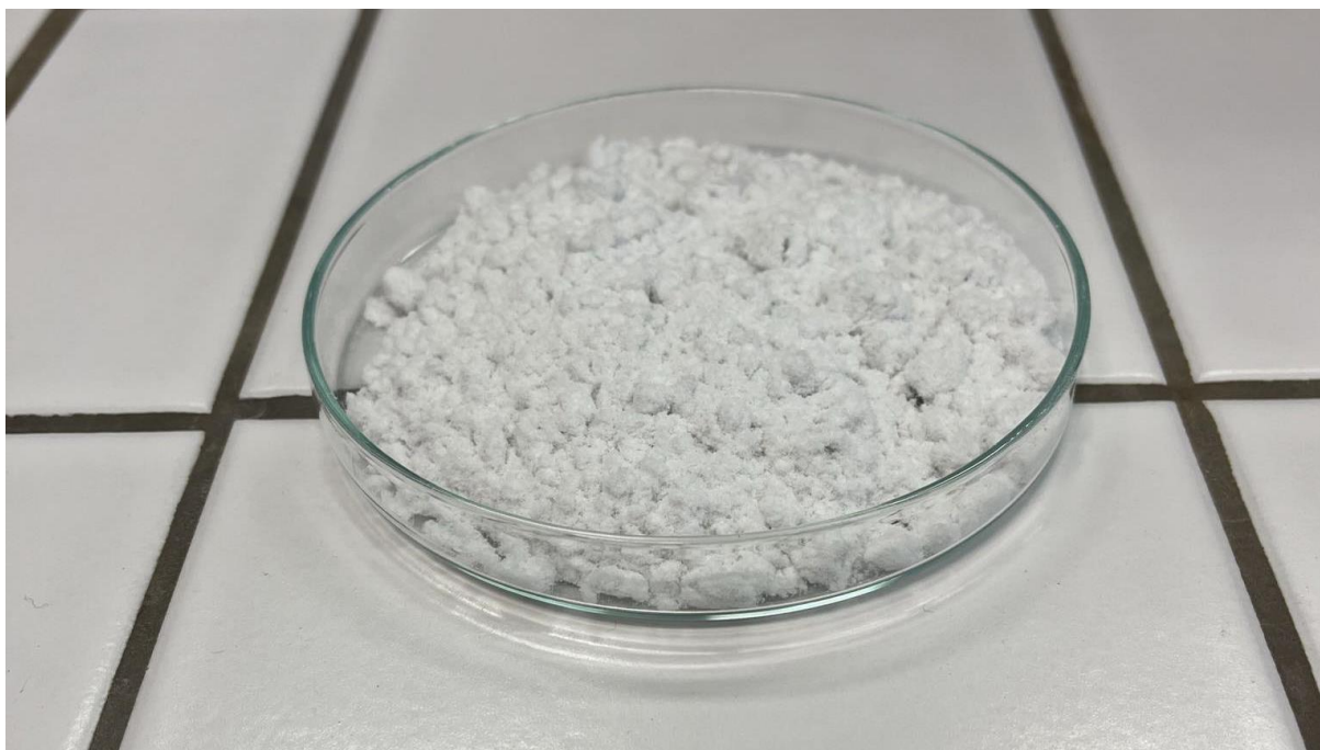
Obrázek 7: PET prach získaný z dealdehydizačního sila
