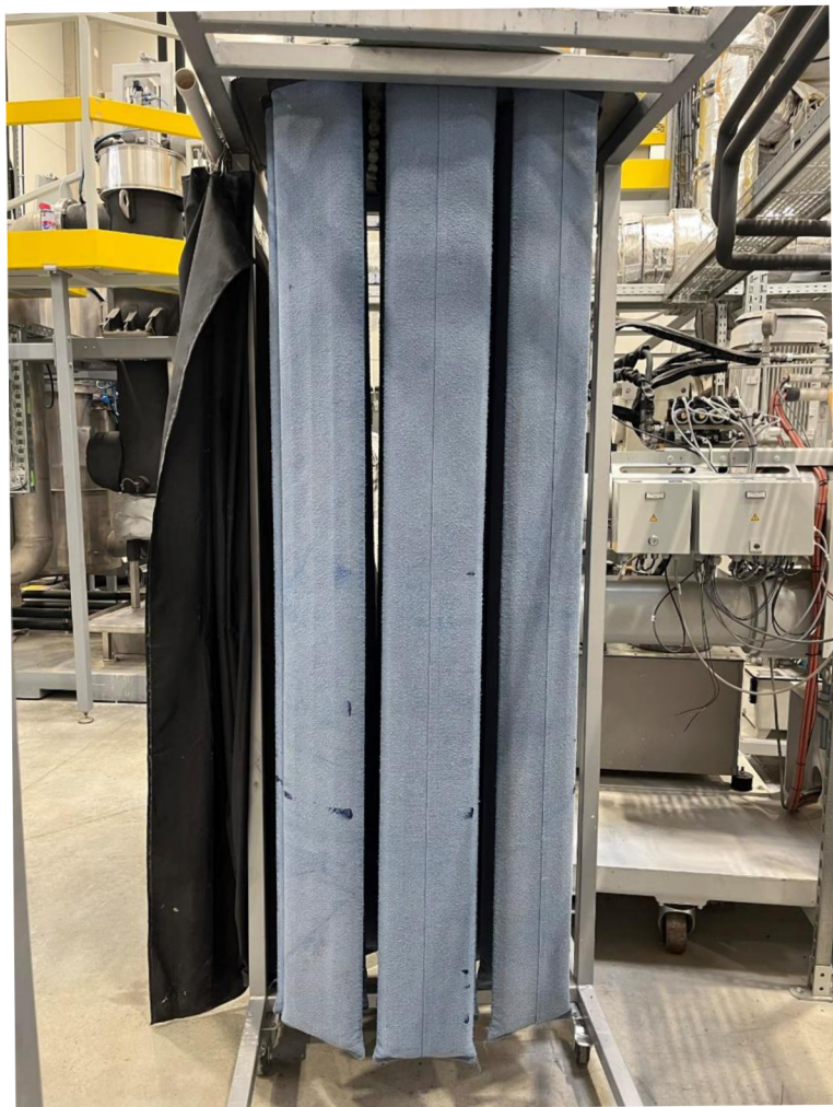
Obrázek 11: Sada textilních filtrů
