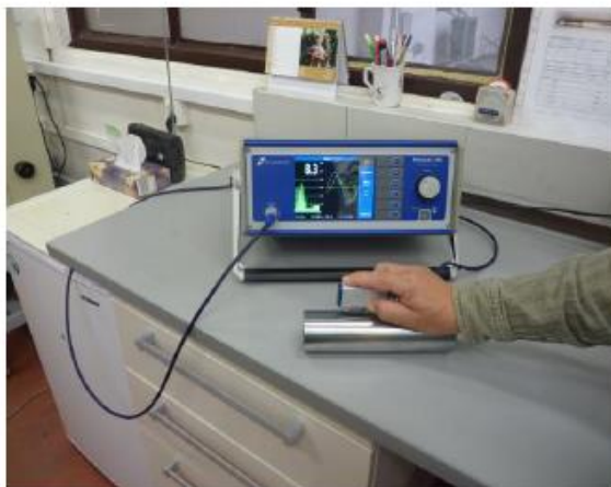
Obr. 19 Průběh měření Barkhausenova šumu na přístroji ROLLSCAN 350 unit STRESSTECH
