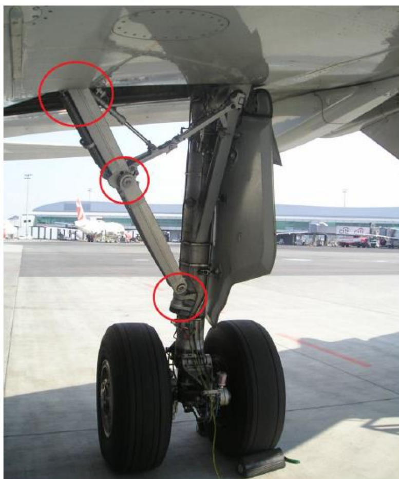
Obr. 9 Levá podvozková noha s kompletním zajišťovacím systémem tzv. Side Stay [14]
