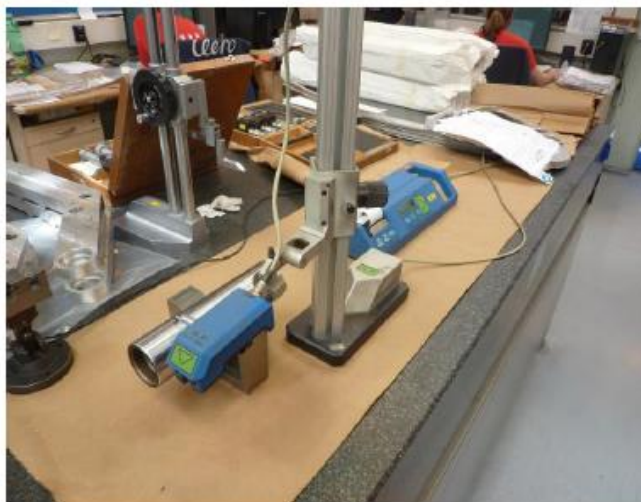
Obr. 17 Měřicí přístroj Hommel tester LV 15 T1000-E na měření aritmetické úchytky profilu R_a a nosného podílu profilu t_p
