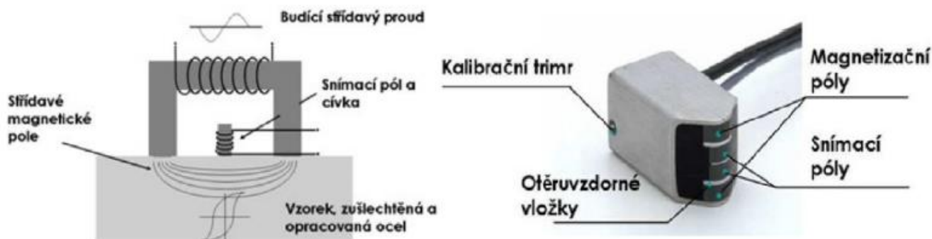
Obr. 7 Princip a konstrukce měřicího snímače [17]
