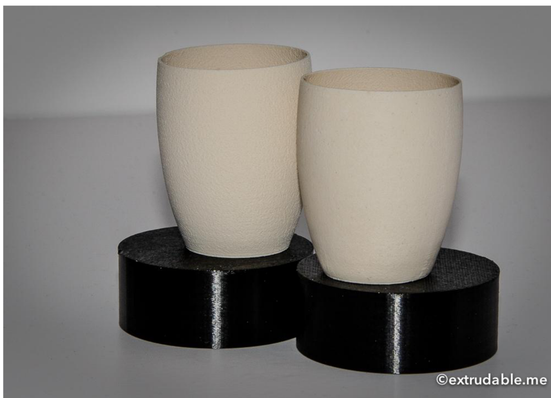
Obr. 13 Hrníčky vytištěné materiálem s plnivem na bázi křídý. 42
