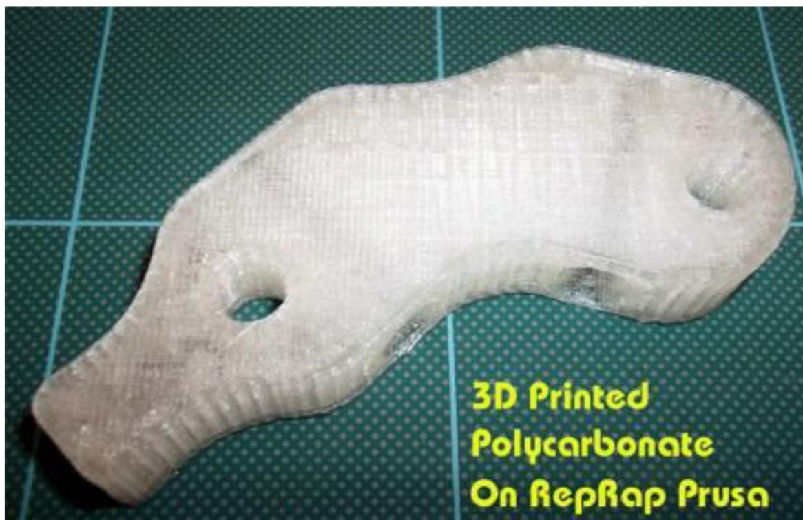
Obr. 11 Součást vytištěná polykarbonátem na tiskárně RepRap. 34
