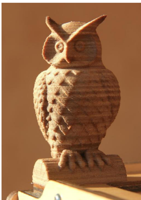
Obr. 12 Model vytisknutý materiálem s dřevěným plnivem. 40
