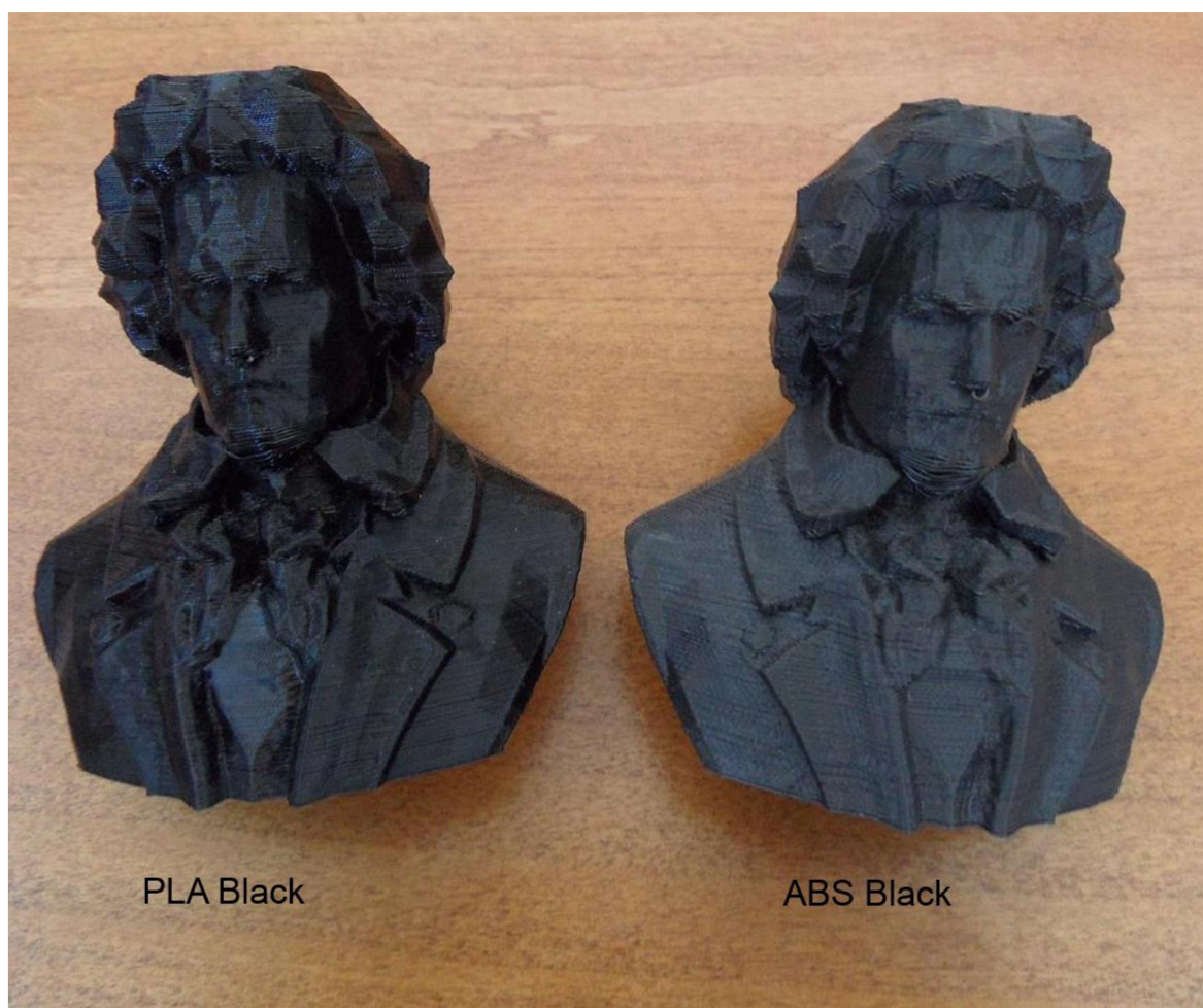
Obr. 10 Součást vytisknutá materiálem PLA (vlevo) a ABS (vpravo). 26
