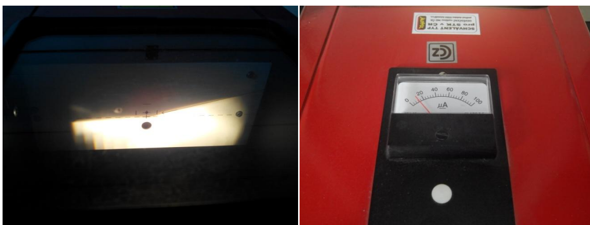
Obrázek 10. měření intenzity světla a průmět paprsků na clonu regloskopu (zdroj: vlastní)
