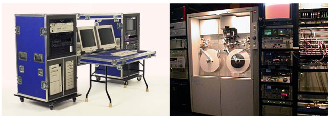
Obrázek 3: Nelineární stříhový systém Avid Symphony, systém telecine s digitálním filmovým skenerem, převzato z [28] a [27]
