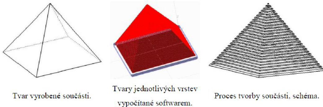
Obr. 2.1: Obecný princip technologie RP (23)
