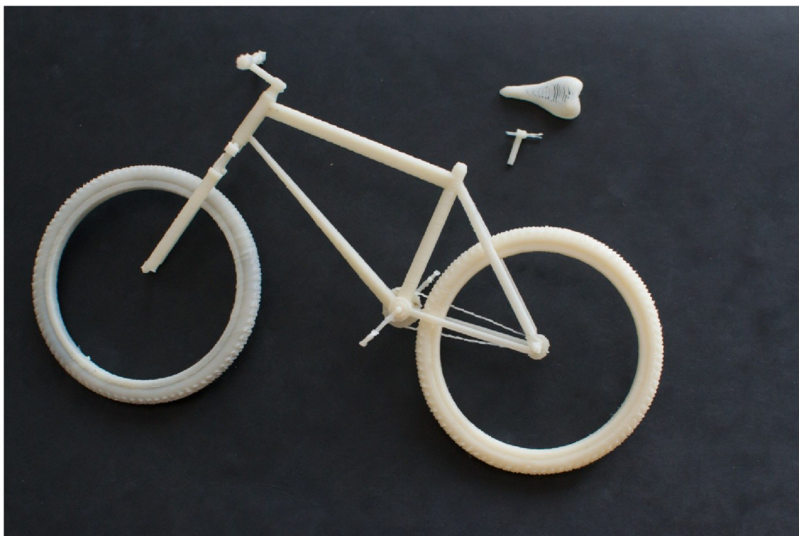
Obr. 4.8: Model jízdního kola po vytáhnutí z ultrazvukové pračky (Zdroj: Vlastní tvorba)
