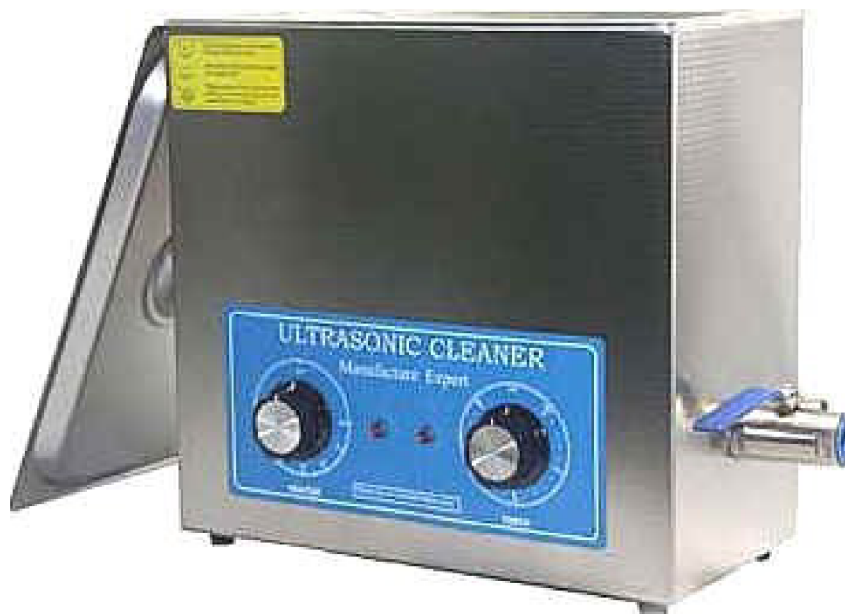
Obr. 4.7: Ultrazvuková pračka potřebná k odstranění podpor (36)
