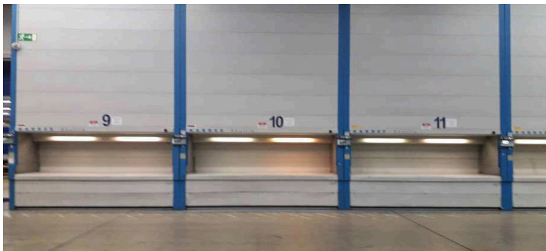
Obr. 1.5 Vertikální karuselový regálový systém-Kardex
