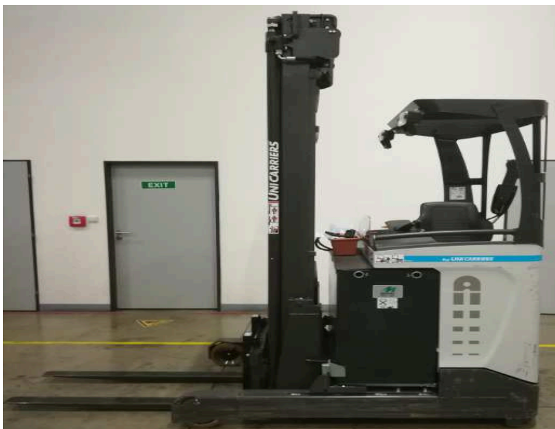
Obr. 1.10 Manipulační vozík s boční instalací zdvihového zařízení
