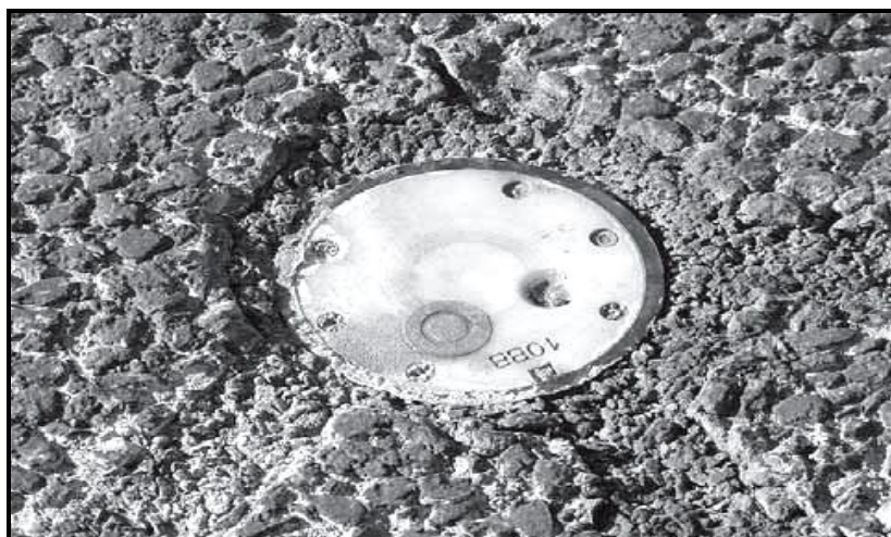
Obr. 9 Silniční senzor Lufft (Sulan a Škuthan, 2005)
