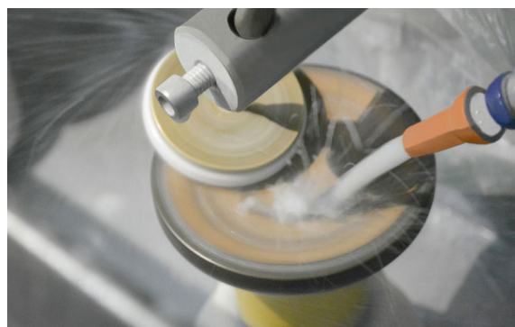
Obr. 2.2: Leštění pomocí leštící podložky [16]
