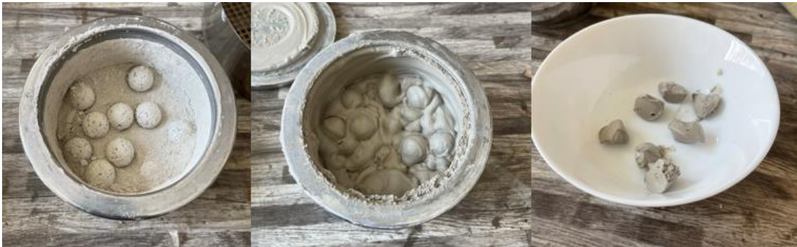
Obrázek č. 36: Suché mletí (vlevo), mokré mletí (uprostřed), vytvořené sbalky (vpravo)
