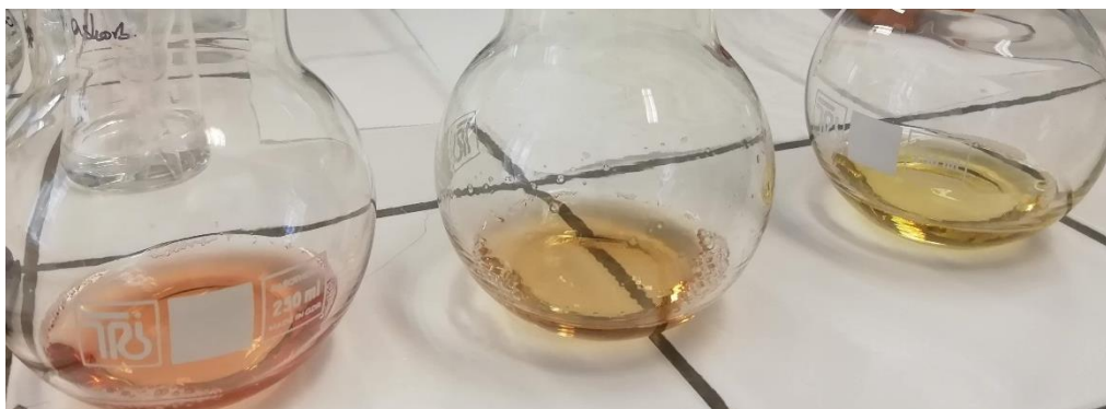
Obrázek 14: Stanovení vitamínu C pomocí titrační metody, vlevo vzorek po titraci, uprostřed vzorek s pravděpodobným bodem ekvivalence, vpravo vzorek před titrací
