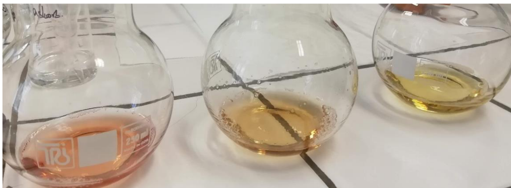
Obrázek 14: Stanovené vitamínu C pomocí titrační metody, vlevo vzorek po titraci, uprostřed vzorek s pravděpodobným bodem ekvivalence, vpravo vzorek před titrací
