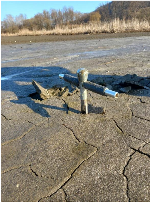
Obrázek 10: Odběr jádra žlábkovým odběrákem, vlastní fotografie (1. 3. 2023)
