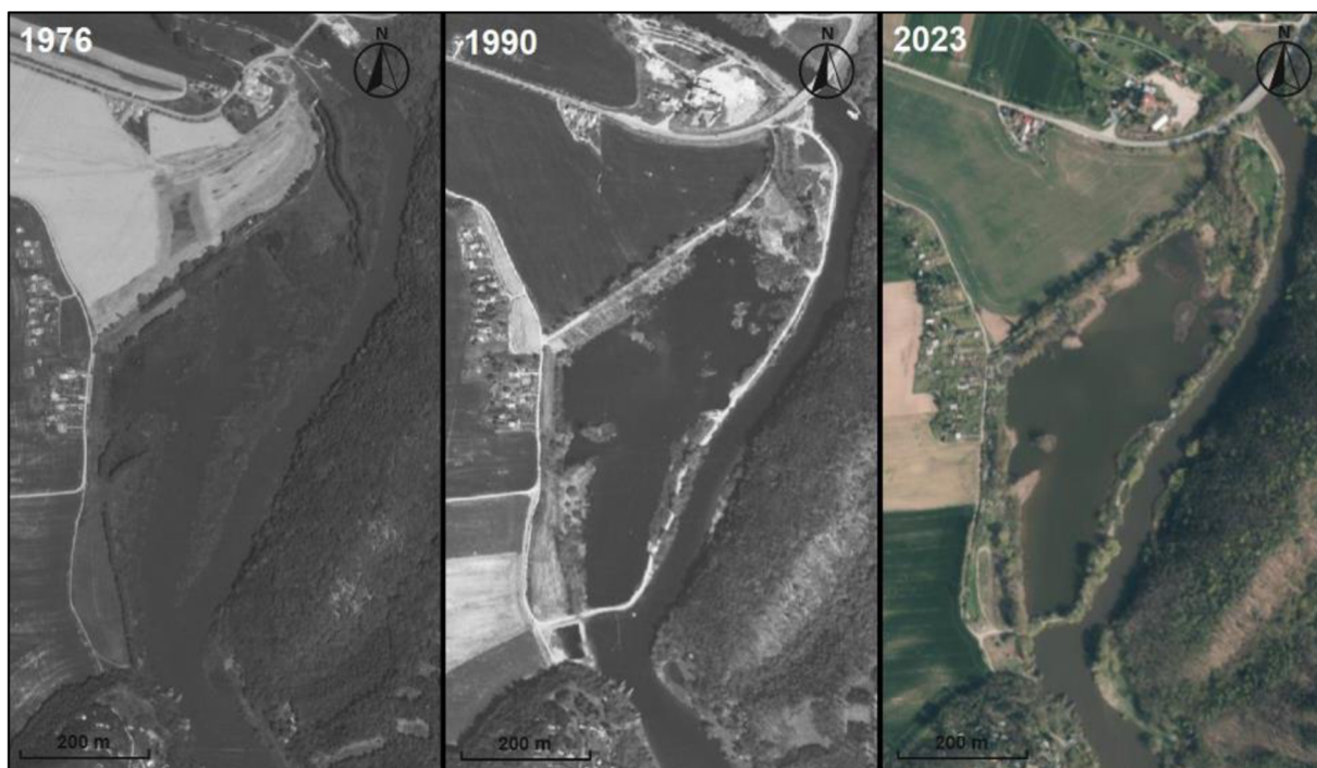
Obrázek 6: Historická a současná ortofota zachycující výstavbu průčezné hráze a celkovou změnu podoby rybníka, gis.brno.cz (upraveno).
