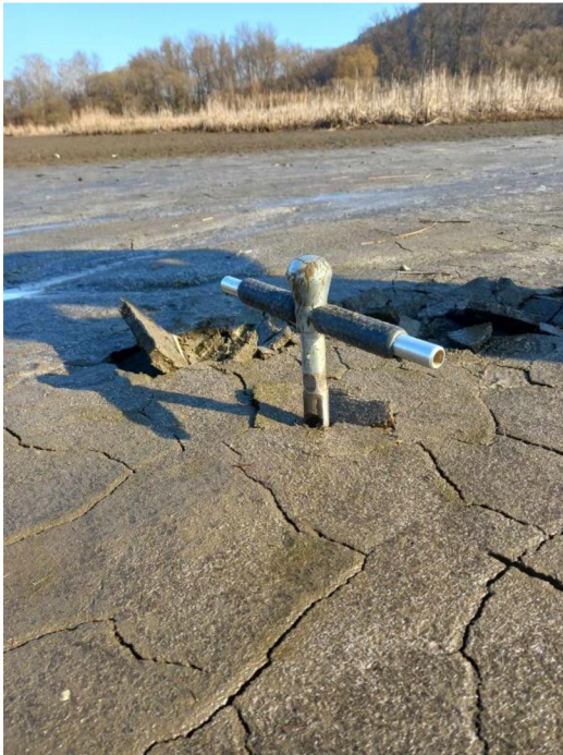
Obrázek 10: Odběr jádra žlábkovým odběrákem, vlastní fotografie (1. 3. 2023)
