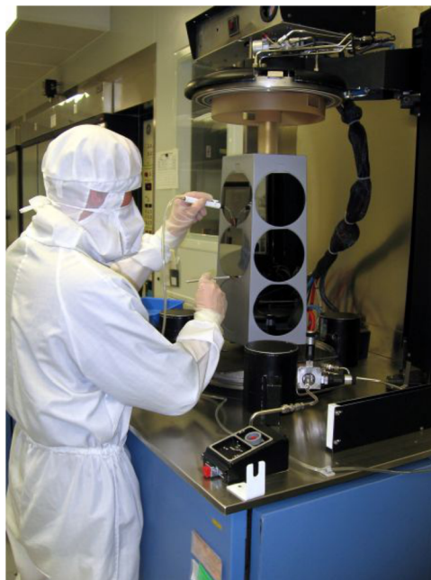
Obrázek 2.2: Operátor v pracovním obleku určeném do čistých prostor [8].
