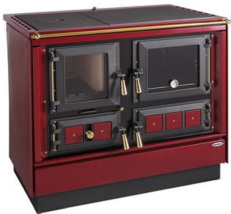
Obr. 8 Kuchyňský sporák na dřevo s troubou. Na levé straně spalovací komora, napravo trouba. Lze si všimnout přívodu sekundárního vzduch průduchy na straně desky
