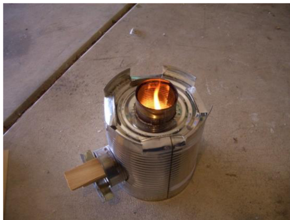
Obr. 6 Jednoduchý raketový sporák vytvořený z plechovek
