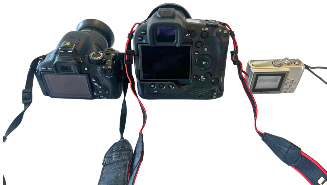
Obr. 10: Porovnání zleva zrcadlovka, bezzrcadlovka, digitální kompakt
