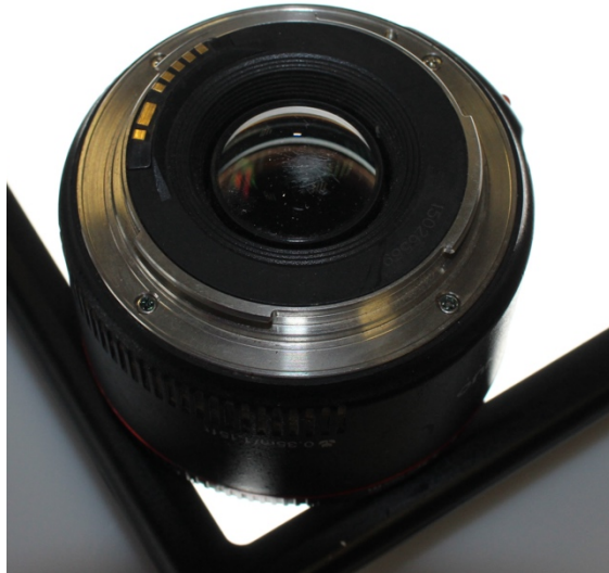
Obr. 30: Poškozená čočka objektivu značky Yongnuo
