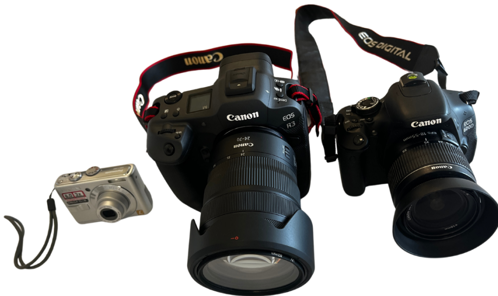
Obr. 9: Porovnání zleva digitální kompakt, bezzrcadlovka, zrcadlovka
