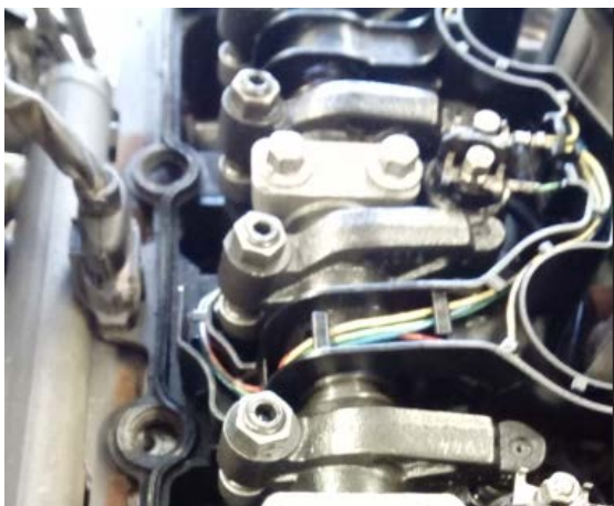
Obr. 1- 7 Konektor připojen na těsnění víka ventilů
