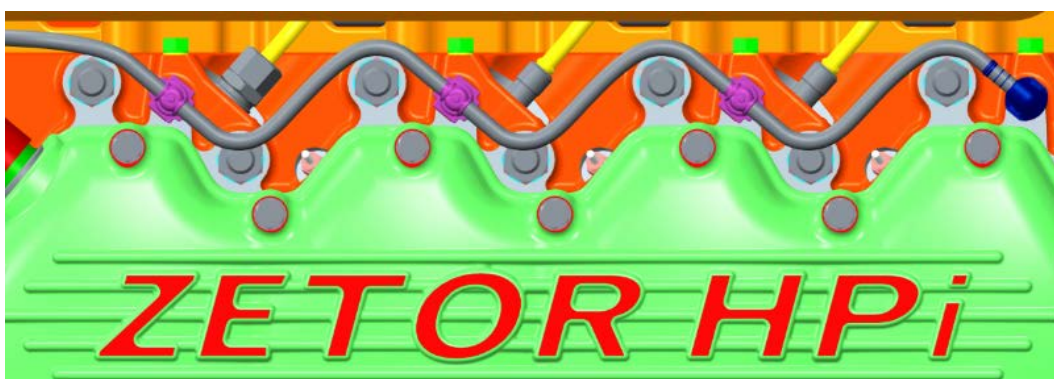
Obr. 2- 57 Přepad od vstřikovačů – spojení spigoty, rychlospojky, hadičky
