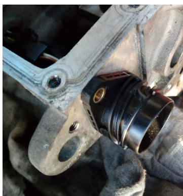
Obr. 1- 9 Dosednutí konektoru PD k bloku motoru
