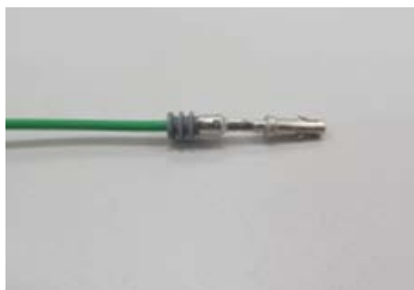
Obr. 2- 24 Vodič 0,75 mm 2 se zakončením pro konektor
