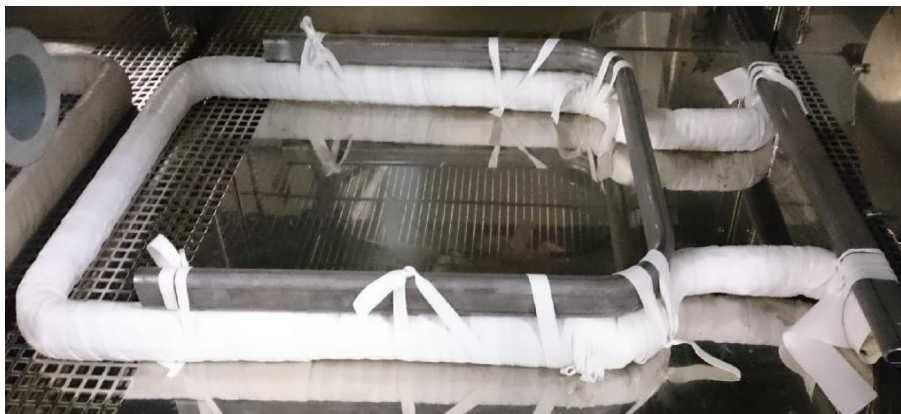
Obr. 135 Vytvrzenování otevřeného rámu s výztuhami
