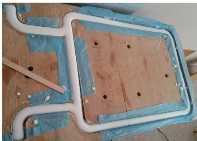
Obr. 125 Odlévání rámu z epoxidové směsi
