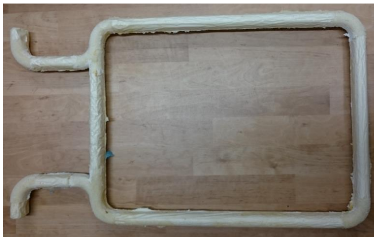
Obr. 124 Výsledný tvar vypěněného PUR jádra rámu po slepení obou polovin (nečištěný)
