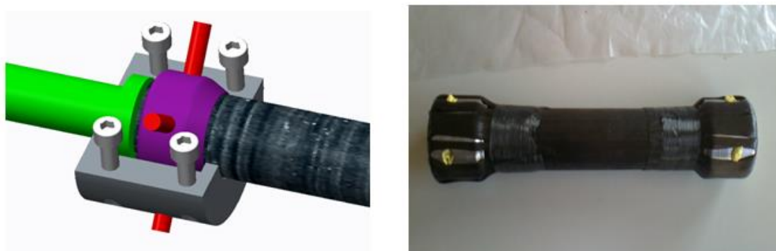
Obr. 70 Model upnutí do kroužku s kolíky a připravená trubka se zataveným kroužkem
