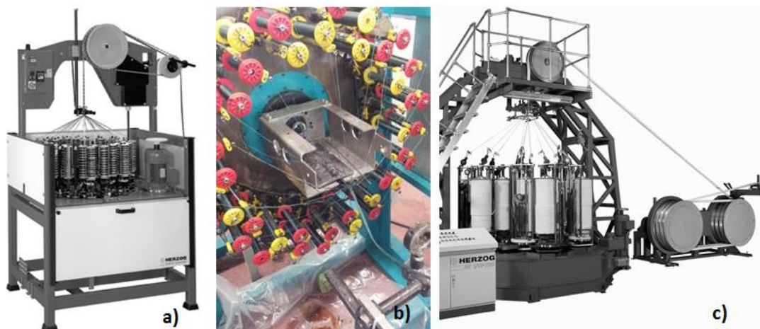
Obr. 30 Konvenční oplétací zařízení: a) výrobce „Herzog“ starší typ b) Zařízení univerzity UMimho, c) Oplétač lan využívaných v offshore stavitelství a dopravě
